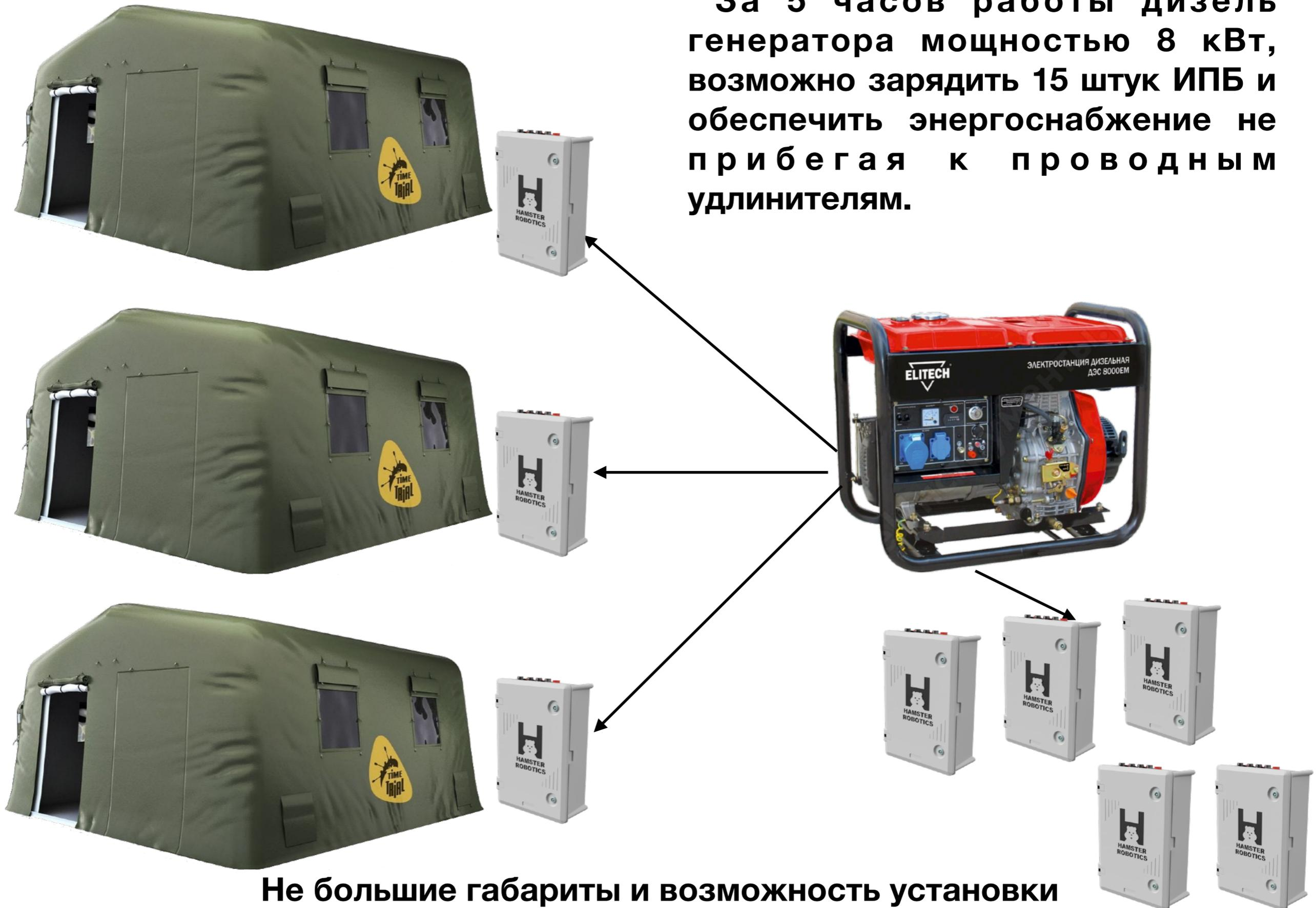
**Не большие габариты и возможность установки на тележку, позволяет быстро производить смену разряженного ИБП на вновь заряженного.**
